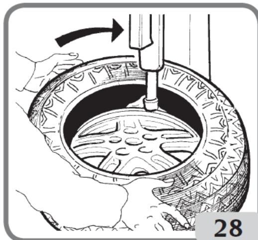
回転テーブルのペダルを踏み時計回りに回転させビードを組み付けて下さい。
