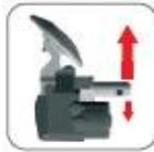
レバー(図5.5 - 6)を操作してビードブレーカーディスクに予圧(図6.20)を加えます。
