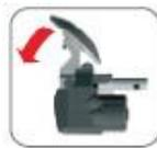
必要に応じて、レバー(図5.5 - 6)を使用して下部ビードブレーカーディスクをわずかに持ち上げ、ビードがリムから完全に外れるようにします。
