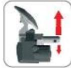
レバー(図5.5 - 6)を操作して、下部ビードブレーカーディスクを上部リムエッジから最大約 5 mm 上に移動します。(図6.32)
