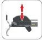
ツールを上にもって操作して可動ツールを作業領域から遠ざけ、ヘッドユニットを外します。
