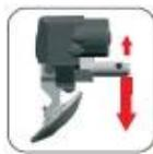
上部ビードブレーカーユニットのレバー(図5.5 - 5)を操作して、上部ビードブレーカーユニットを静止位置から動作位置まで下げます。
