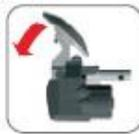
ボタン(図5.5 -3)を押すと、ビードブレーカーディスクの角度が変わります。
