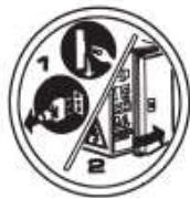
ホイールバランサーでメンテナンス/修理を実行する前に、電力供給ケーブルを抜いて下さい。
