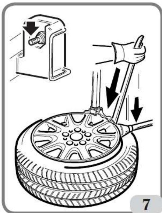
プレスローラーを取り除き、プレスパッドをマウント/ディマウントツールの反対側に位置してください。
