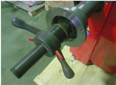
ロックハンドルを締め付けていくと、プレートが押されスプリングが縮んで行きます。
