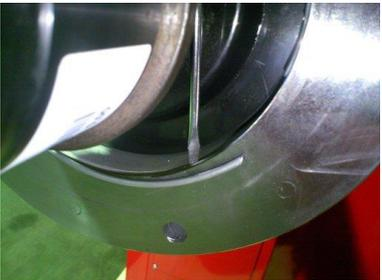
溝から抜け止めのリングを細いドライバーで外します。
