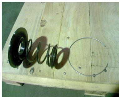
外したスプリングと抜け止めのリングです。
