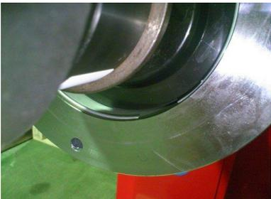
スプリングが縮んでいる状態で、左の写真の様に溝に外れ止めのリングが付いています。
