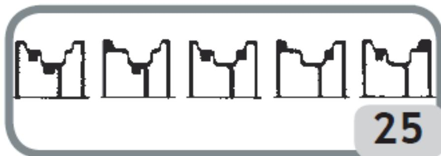
標準的なALUプログラムでは、いろいろなウェイトの貼り付けモードが選択可能です。(図25)そしてアルミホイールデータの設定を維持して正確なアンバランス値を提供します。
