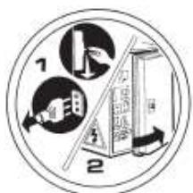
いかなる機械のメンテナンス/修理をを実行する前に電源供給プラグを外して下さい。
