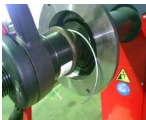
左の写真の様に外し、リングを抜き取ります。
