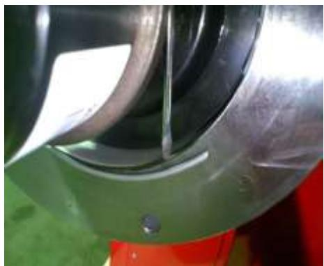
溝から抜け止めのリングを細いドライバーで外します。
