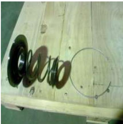
外したスプリングと抜け止めのリングです。
