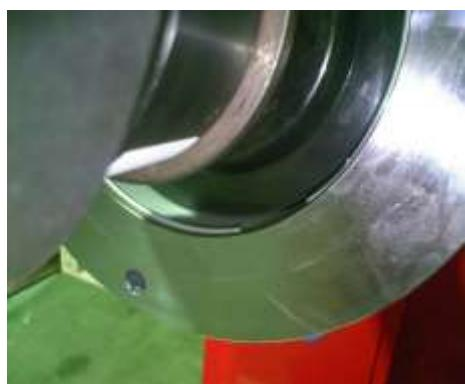
スプリングが縮んでいる状態で、左の写真の様に溝に外れ止めのリングが付いています。
