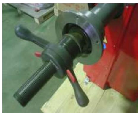
ロックハンドルを締め付けていくと、プレートが押されスプリングが縮みます。
