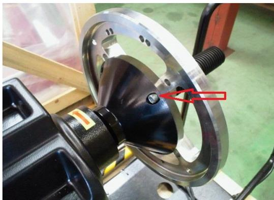
上写真の矢印部分と反対側の2か所を付属のボルトで固定して下さい。
