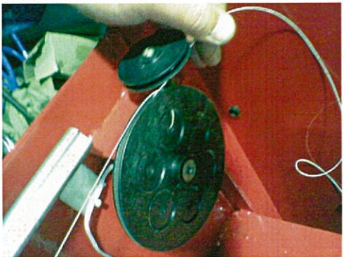
③ポテンショメーターの軸に滑車をはめ込む
