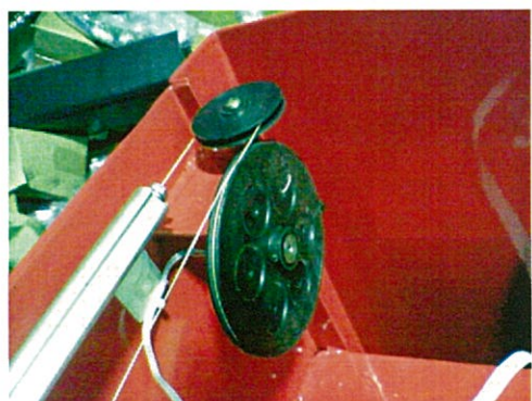
⑦滑車のつけ根にあるイモネジ2箇所を締め滑車を固定して完成
