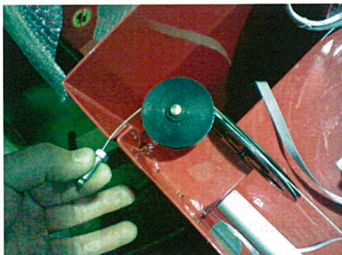
⑤残りのワイヤーを小さいほうの滑車に反時計回りに半回転巻く
