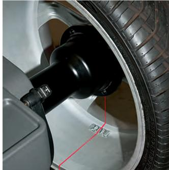
ディスタンス、リム径、リム幅もセンサーで自動入力
